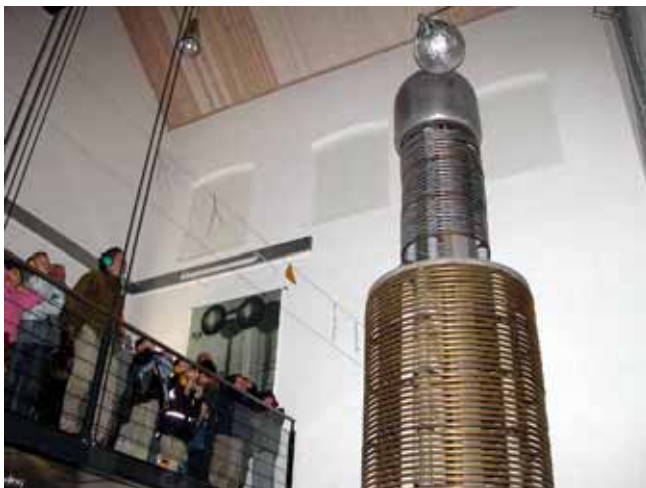
Niels Bohr's 7 meter høje Van de Graaff generator.
